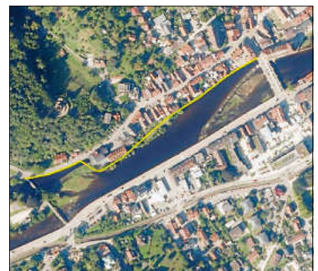
Lageplan der Hochwasserschutzlinie
