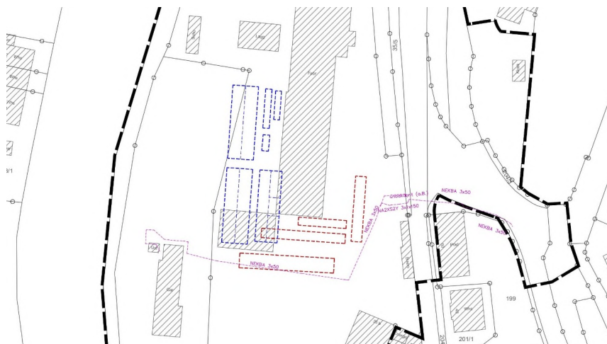
Bild 13: Standorte der ehemaligen Tauchbecken (blau) und Tröge (rotbraun)
